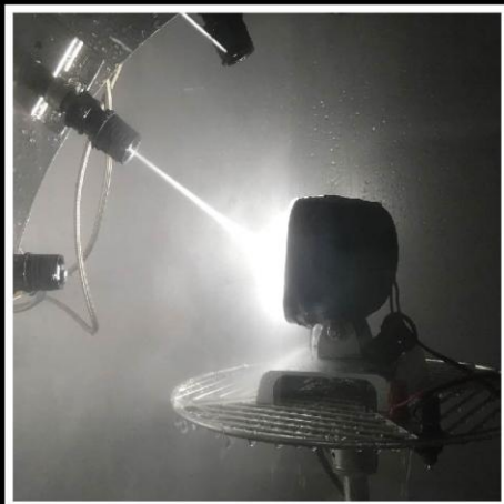
Water Resistance Test 防水測試
